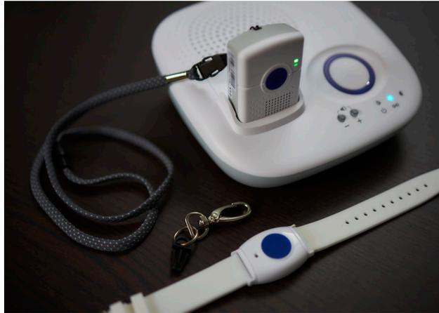
Basisstation mit herausnehmbarem Mobilgerät und Handsender
